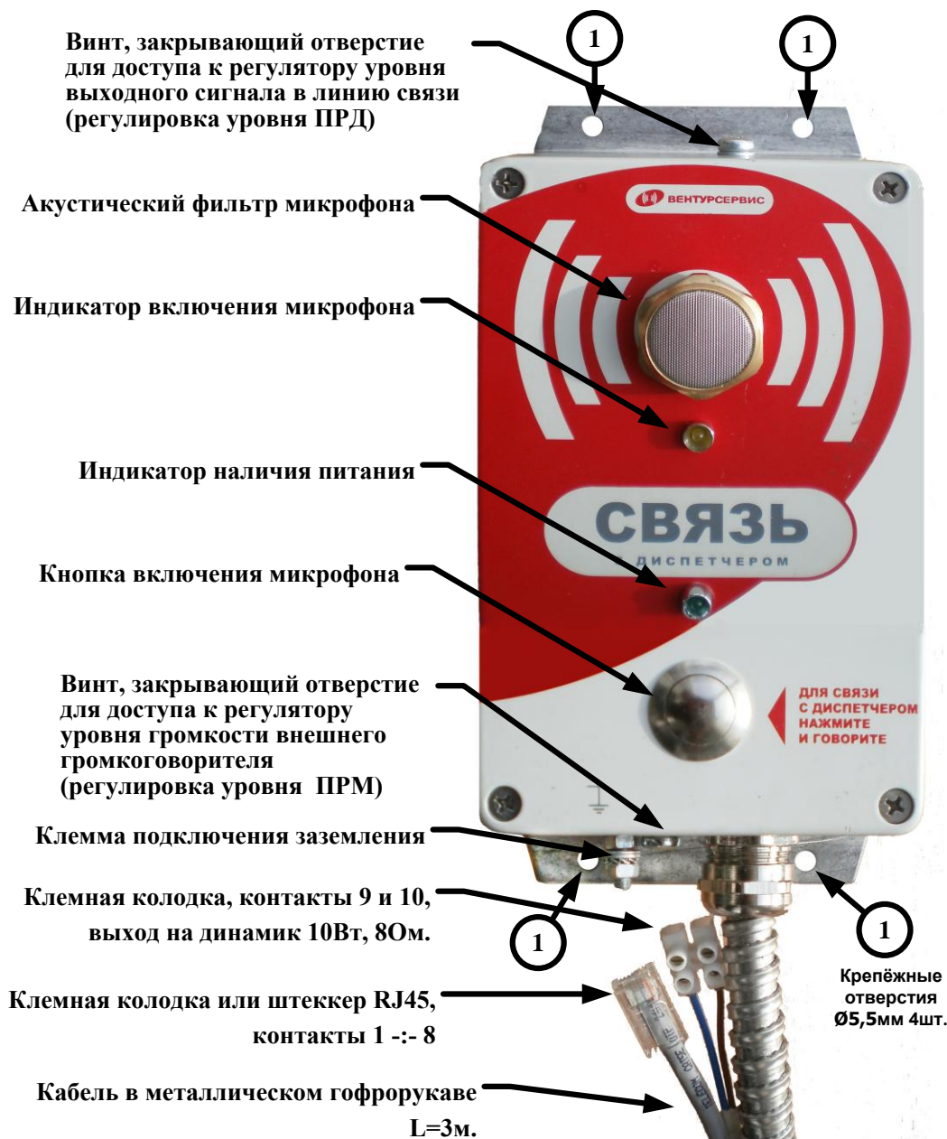
Рис. 4.5.5.1 Внешний вид и назначение органов управления абонентского пульта участника выносного АП.М.24.
